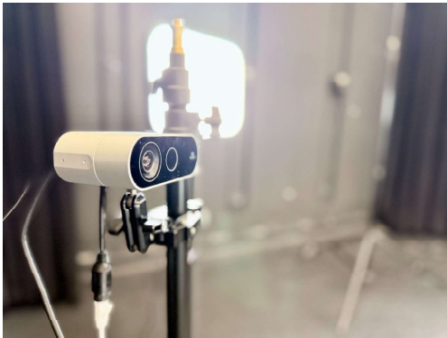
Fig. 28. Microsoft Azure Kinect DK Depth Sensor Unit.
