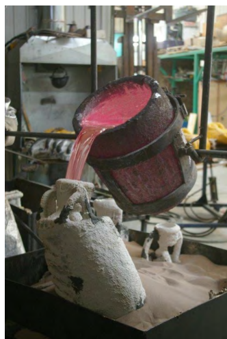
Figure 7. Aluminium pour of the salmon project
